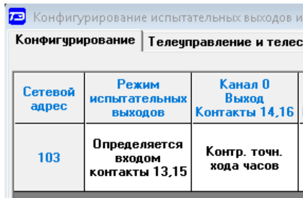
Рисунок 12 Конфигурирование испытательного выхода на формирование сигнала контроля точности хода часов
