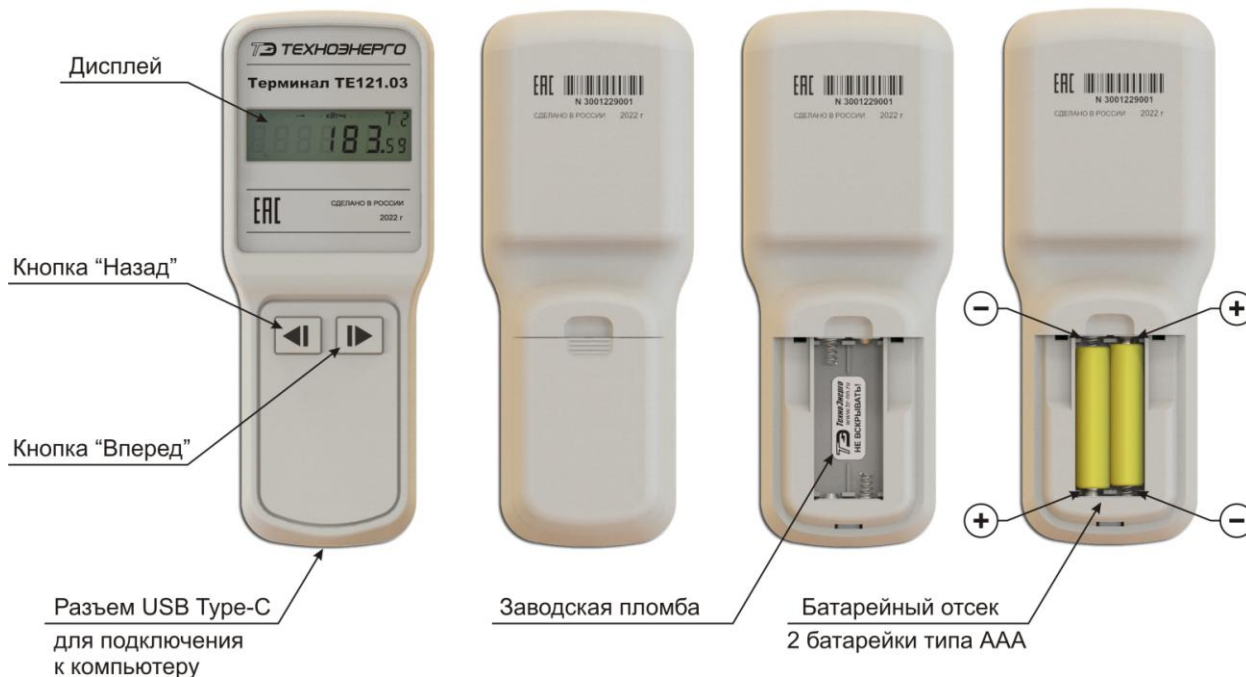
Рисунок 1 - Внешний вид и органы управления терминала ТЕ121.03
