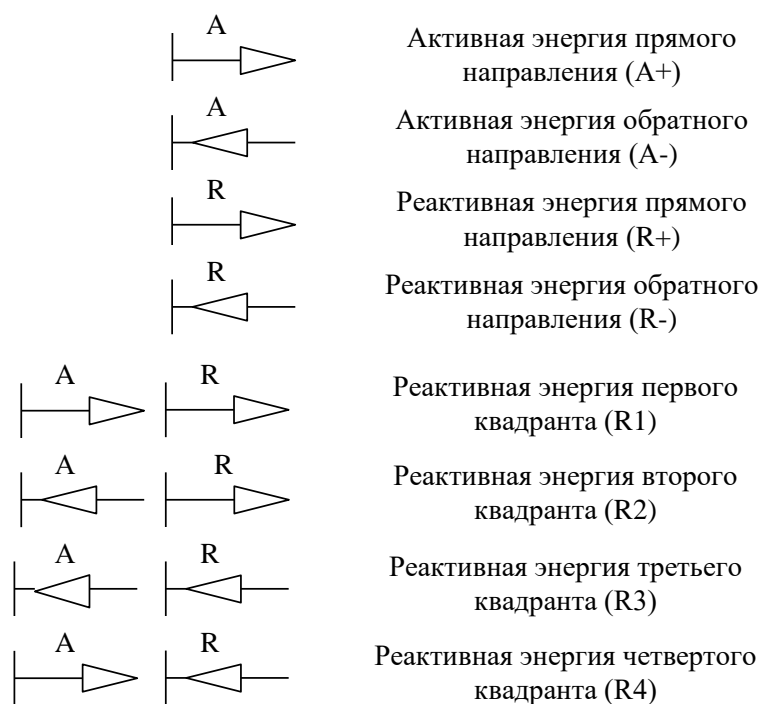
Рисунок 3 – Условные обозначения направления энергии, нанесенные на шкалу счетчика
