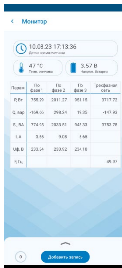
Рисунок 10 – Раздел «Монитор» мобильного приложения «Монитор ТЭ», таблица для трехфазного счетчика
