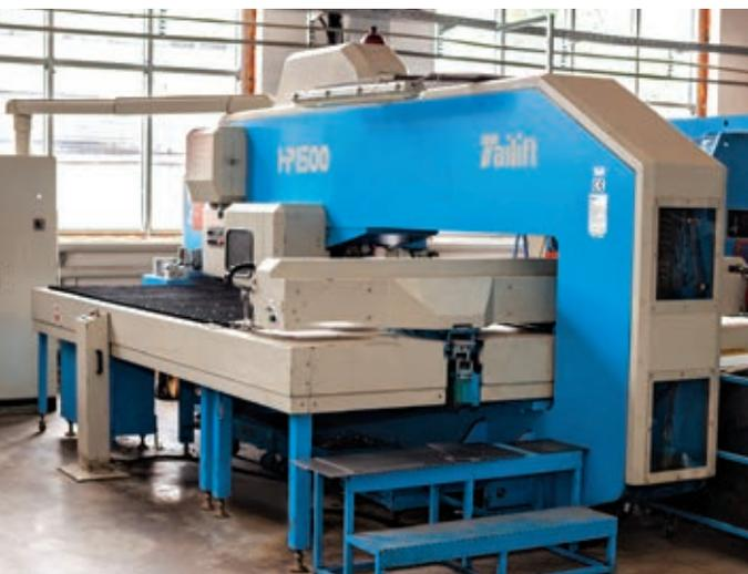
Оснащено 3-х и 4-х координатными вертикальными и горизонтальными обрабатывающими центрами, токарными автоматами с приводным инструментом, многофункциональным листообрабатывающим комплексом на базе ПКР и листогибочного 5D пресса, широким парком универсального токарно-фрезерного оборудования, механическими прессами усилием от 6 до 100 тонн.
