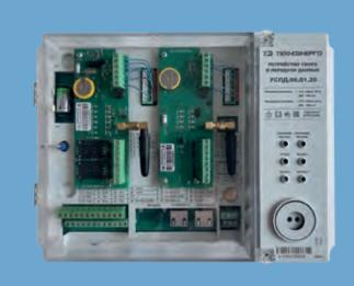
УСПД предназначены для автоматизации учёта энергоресурсов и диспетчеризации объектов энергетики, промышленности и ЖКХ как в автономном режиме, так и в составе автоматизированных информационно-измерительных систем коммерческого учёта электроэнергии и мощности (АИИС КУЭ), комплексов устройств телемеханики.
