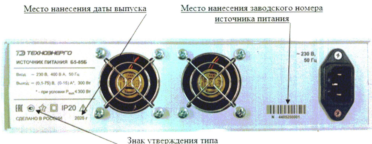
Рисунок 2 – Задняя панель источника питания с обозначением мест нанесения заводского номера, даты выпуска и знака утверждения типа
