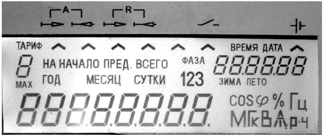
Рисунок 5 – Внешний вид ЖКИ с включенными элементами индикации
