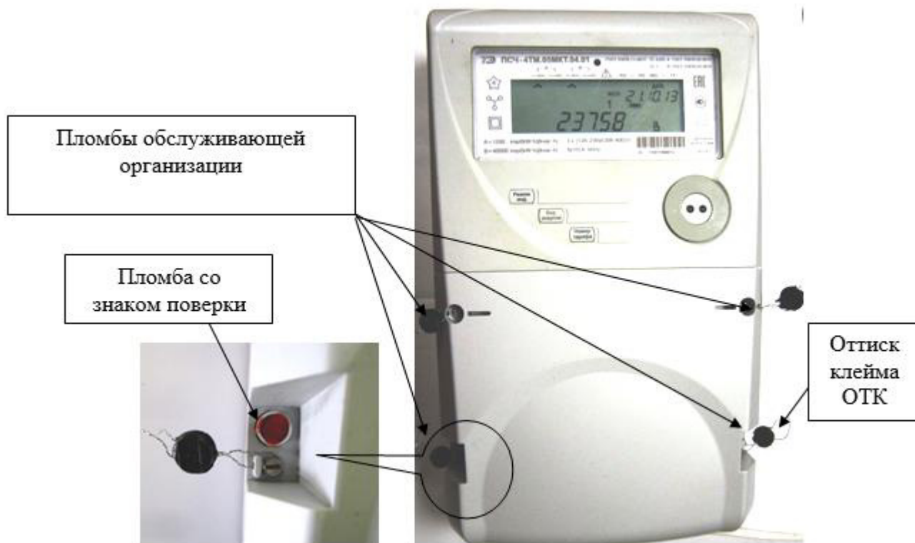
Рисунок 1 – Общий вид счетчика, схема пломбирования от несанкционированного доступа, обозначение места нанесения знака поверки
