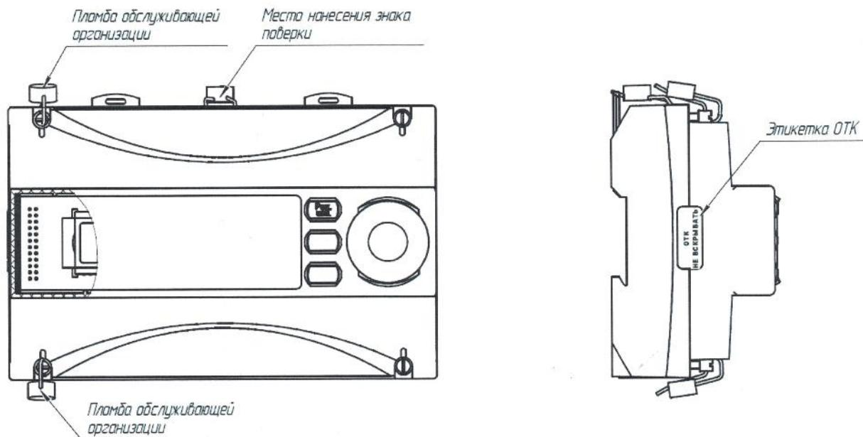
Рисунок 2 – Схема пломбировки от несанкционированного доступа,
