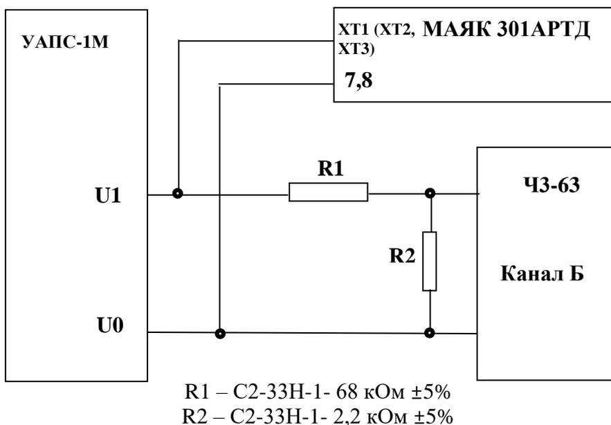
Рисунок 2 – Подключение частотомера к установке УАПС-1М и счетчику
